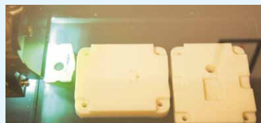
パソコンプリンターと同じようにヘッドが左右に動きデータを形にしてい
