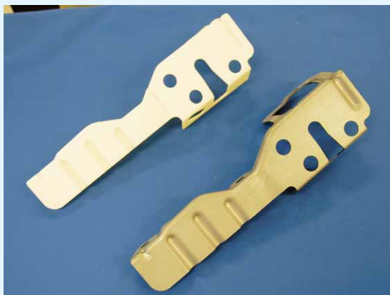
3Dプリンターで作った試作品(上)をもとに金型工法を決定してから金型をおこし完成品(下)をつくる
